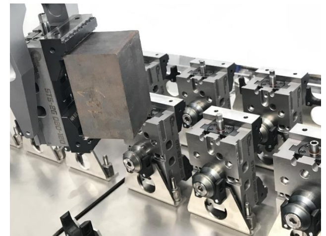
Indirektes-Werkstückhandling mittels Schraubstöcke
