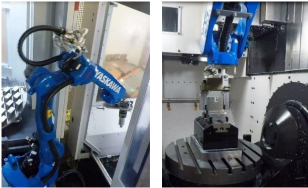
Beispiel: Bestückung einer 5-Achs Fräsmaschine
