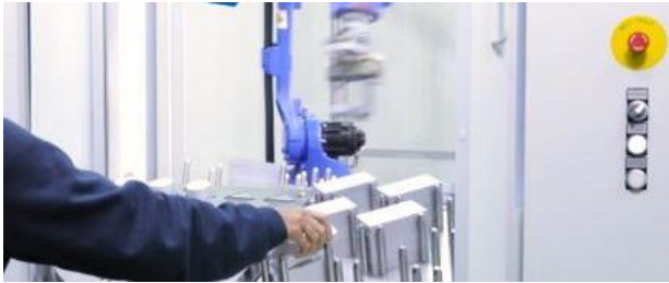
Bediener & Roboter arbeiten hauptzeitparallel an der Zelle
