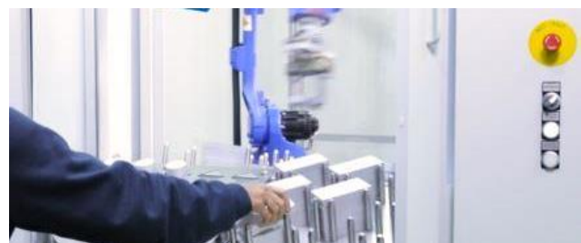
Bediener & Roboter arbeiten hauptzeitparallel
