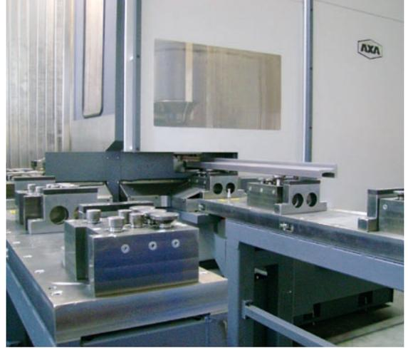
**Herzstück:** Bearbeitungszentrum Axa VHC 50-XTS mit Schwenkkopf sowie das von Jungheinrich entwickelte Spannkonzep für die Schienen.
