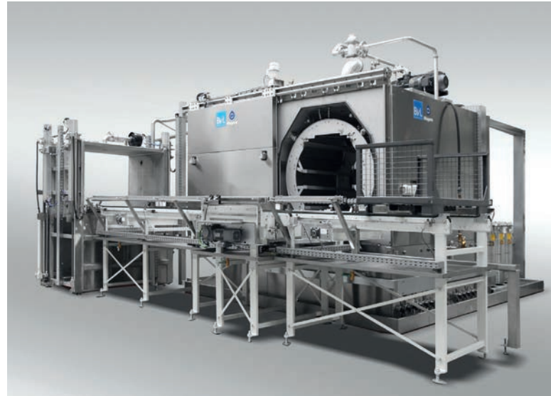
Aufgrund der automatisierten Teilezuführung durch das Regalbediengerät wäscht die Reinigungsanlage nun Tag und Nacht Getriebe und Getriebeteile
